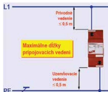
Zapojenie zvodíča DEHNGuard do „T“
