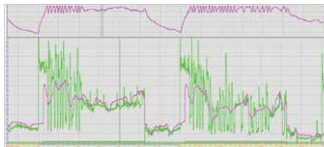
Okamžitá skutočná a „dovolená“ spotreba tepla (hore), teplota v hale v pracovných a nepracovných dňoch (dole), výsledok – automatizované komplexné porovnanie predpisu a skutočnej spotreby tepla budov v prostredí BI
